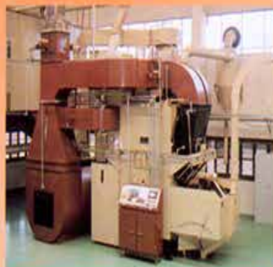
Torrador Opus 40: versão atual do modelo é dimensionada para processar 40 sacas de grãos por hora
